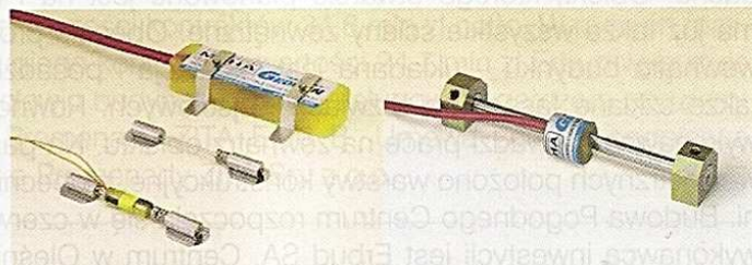
Rys. 1. Strunowe czujniki pomiaru odkształceń (ekstensometri strunowe): czujnik zgrzewany do konstrukcji stalowych (fot. po lewej), czujnik mocowany do konstrukcji drewnianej (po prawej) [7]
